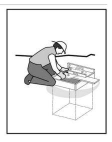
7.1.6 После закрепления фундамента снять опалубку и прикрепить опору мачтыфлагштока через петли на пластинах закладного крепежа и опоры.
